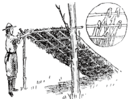
リンツターの作り方(『テント生活の仕方』より)
